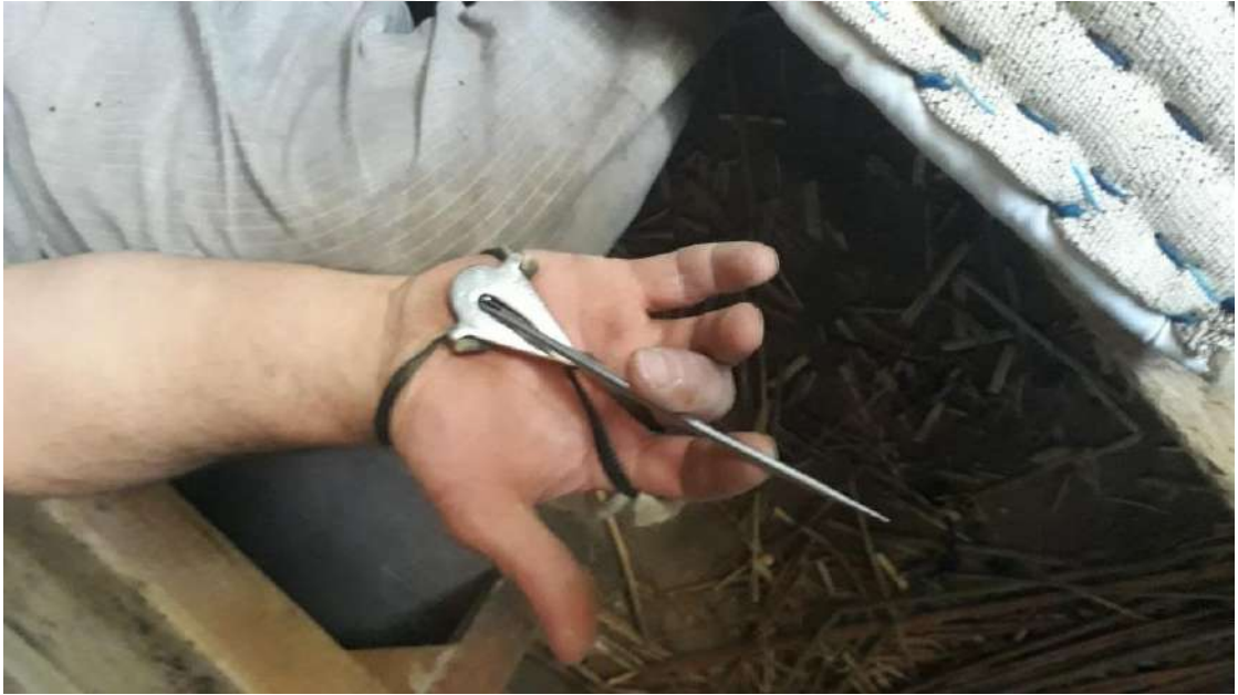
Resim 6. Yörede palan dikmek için kullanılan kefik (kefene).
