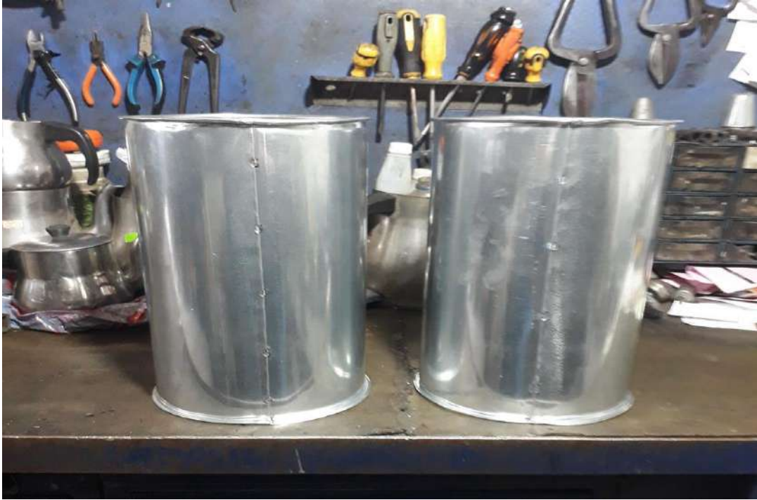
Resim 8. Sütün miktarını ölçmek için kullanılan süt ölçeği.
