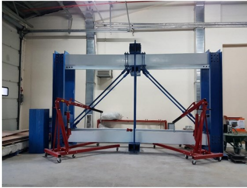
Şekil 1. Çelik yükleme çerçevesi ve Veri toplama sistemi
