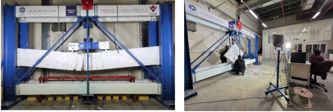
Şekil 2. Kiriş ve duvar panel testi
