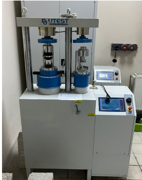
Şekil 1. Çimento Eğilme/Basınç Test Presi genel görünümü
