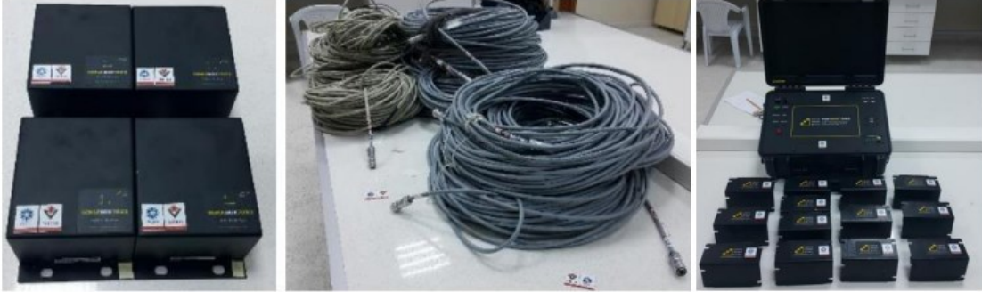
Şekil 1. Kablolu ivmeölçer sensörler ve dinamik veri toplama sistemi
