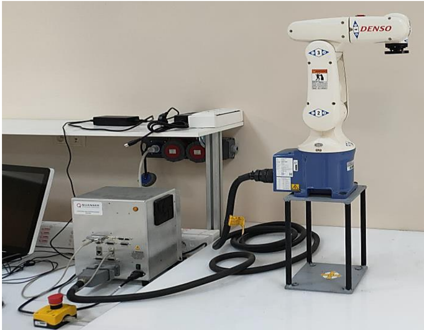
Şekil 1. Denso 6-DOF Robot Sistemi Deney Seti
